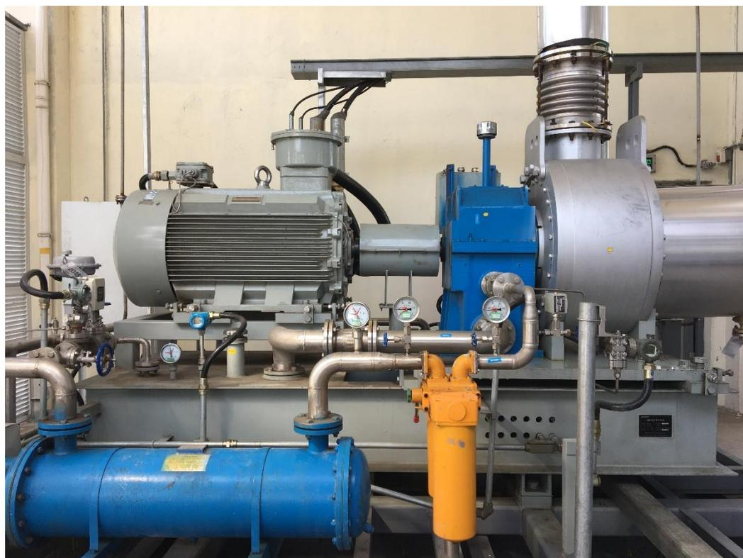
涡轮膨胀制冷发电机组是利用双氧水氧化系统空气反应后的余量进行做功制冷，从而将氧化尾气中的芳烃蒸汽冷凝液化回收利用，以减少芳烃原料的消耗和对环境的影响，膨胀做功吸热同时可产生电能用于装置动力电供给，降低装置生产成本。
