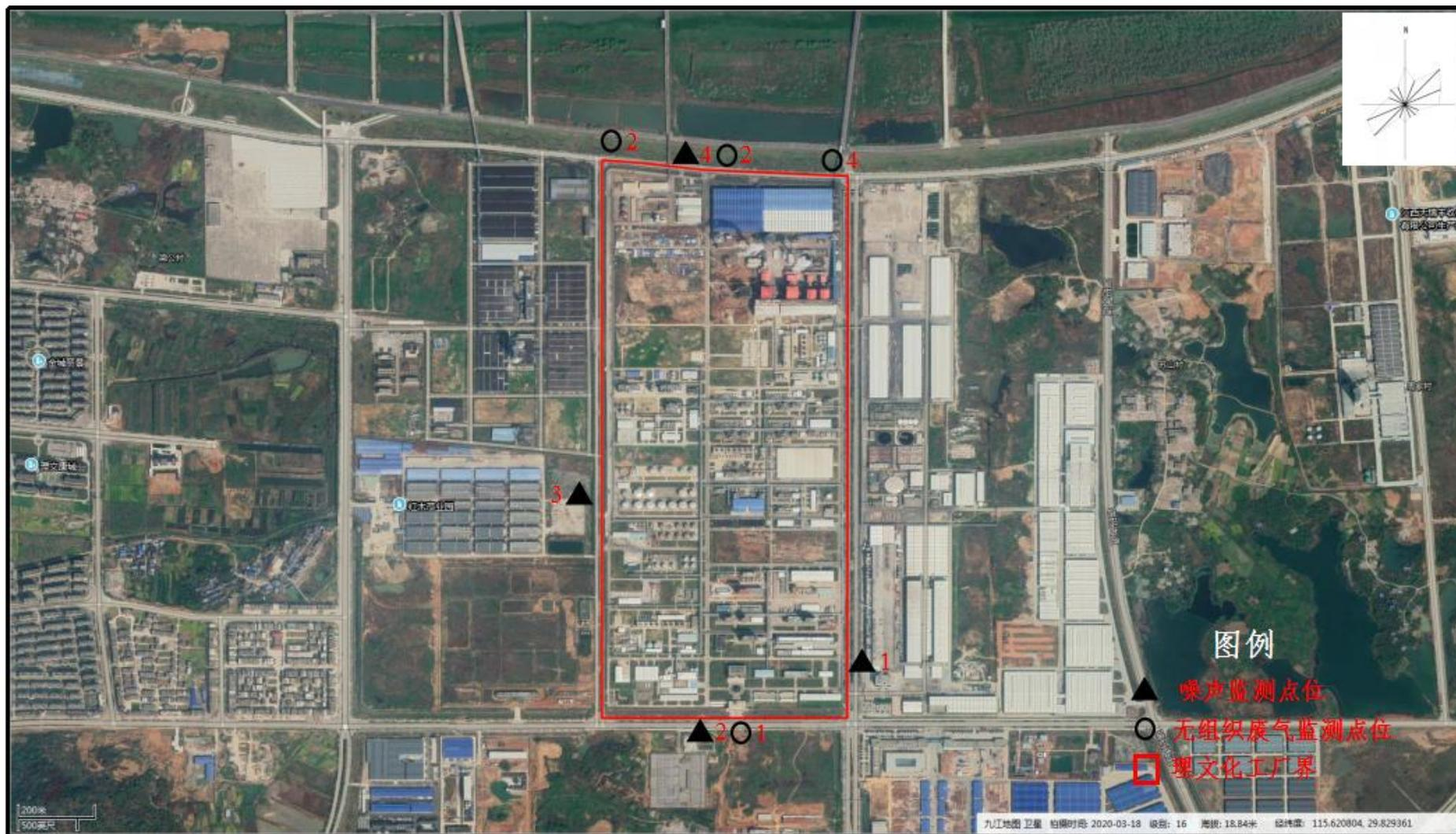
图 7-3 无组织废气和噪声监测布点图
